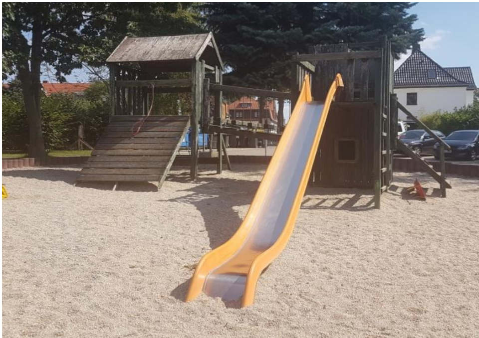
Austausch des kompletten Fallschutzes (50m 3 ) auf Grund von Sicherheitsauflagen
